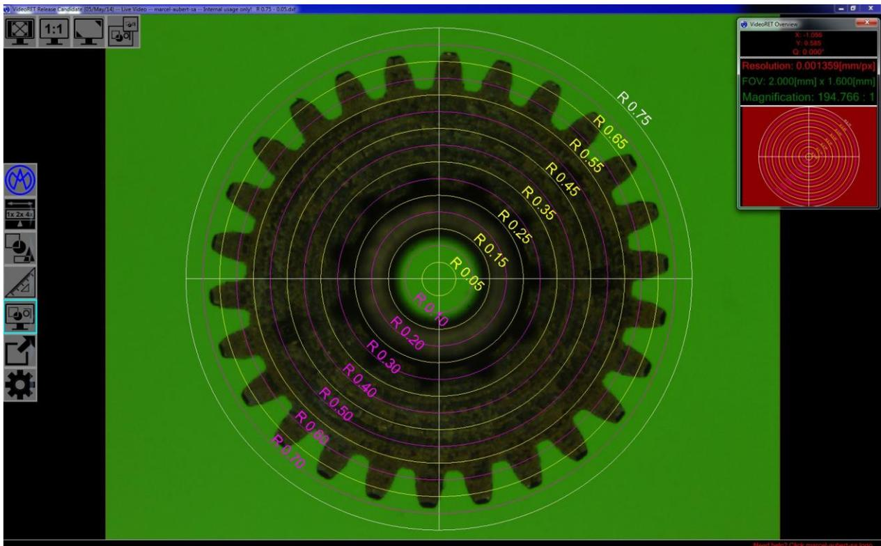
Das Programm VideoRET ist eine schnelle und einfache Lösung, um im Blickfeld, Profile mit CAD-Dateien zu kontrollieren und zu vergleichen.
